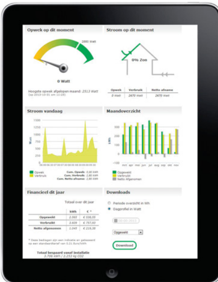
Figuur 7.2: Voorbeeld van een energiemanagementsysteem
